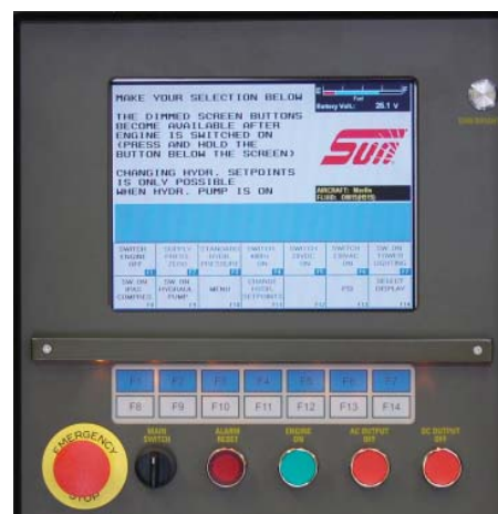
Die optische Qualität des Displays wird durch die Combi-Shield-Lösung nicht beeinträchtigt. Die Entspiegelung ist mit der EMI-Abschirmung kombiniert und sorgt damit für das Extra: gute Lesbarkeit bei direktem Sonnenlicht.
