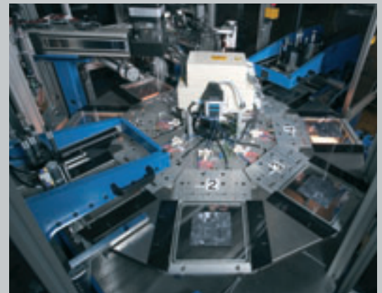
Masina de imprimare in sita pentru celule solare. Avantajele masinilor specifice pentru clienti constau in pozitionarea protectiva si de inalta precizie a waferilor, calitatea constanta a imprimarii cat si in posibilitatea integrarii altor module cum ar fi cuptoare, magazii tampon pentru materiale sau Flashster, dupa cerintele individuale. Prin dispunerea in cerc a procesului de lucru se reduce la un minim manipularea dificila si de durata a celulelor, ceea ce maresta in mod simtitor productivitatea instalatiei.
