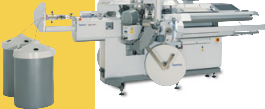
Sertizarea de contacte si aplicarea garniturilor pe una si pe ambele capete ale segmentului de cablu
