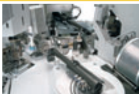
Sertizarea de contacte si aplicarea garniturilor pe una si pe ambele capete ale segmentului de cablu
